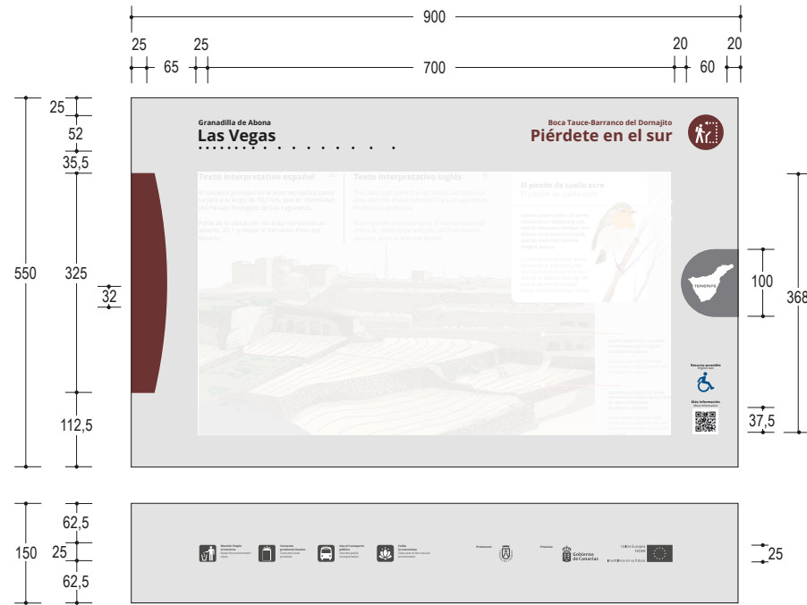
Medidas y distancias para la composición del marco de una mesa interpretativa tipo M3 (90 x 55 cm + 90 x 15 cm faldón).
