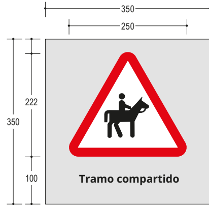
Cartel C1 o C2 (35 x 35 cm), con bandeja tipo a, de tamaño pequeño para una sola unidad de información. Rojo 0C 100M 100A 0N Pictograma Negro Open Sans Bold, 65 p. Negro
